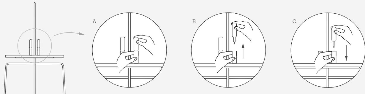
4. Ao colocar a cúpula, desça até encaixar no aro inferior da estrutura.
