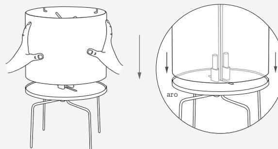
5. Coloque a tampa de acrílico, com o corte no meio alinhado com as antenas e desça até apoiar nos ganchos da cúpula.
